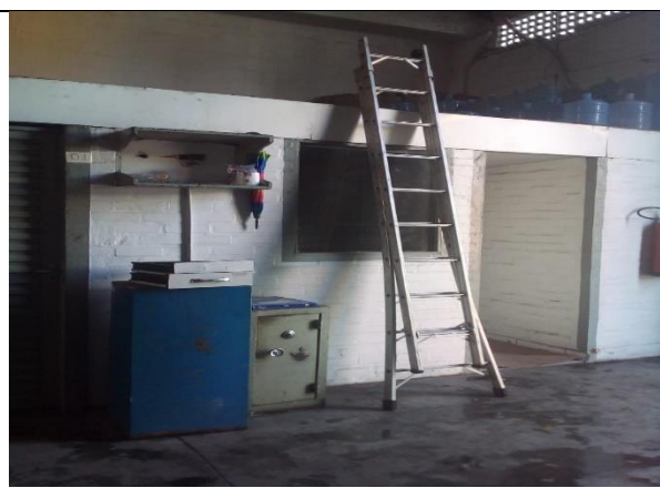
Figura 5 – Escada extensiva de alumínio para acesso ao mezanino
